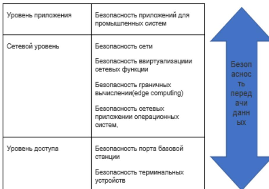
Рисунок 1. Общая схема архитектуры сетевой безопасности 5G
