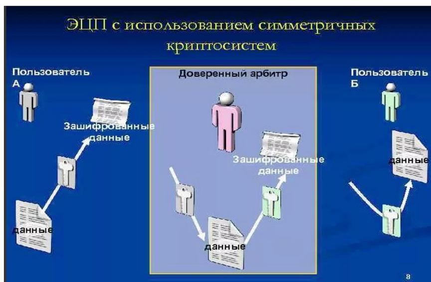
Рисунок 2 - ЭЦП с использованием симметричных криптосистем
