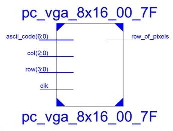
Рисунок 8. Модуль преобразователя ASCII кода символов в изображении
