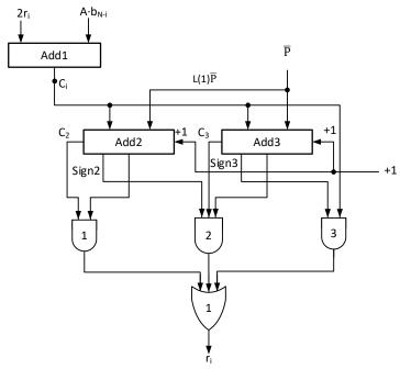
Рис. 2. Функциональная схема формирователя частичных остатков PRF
