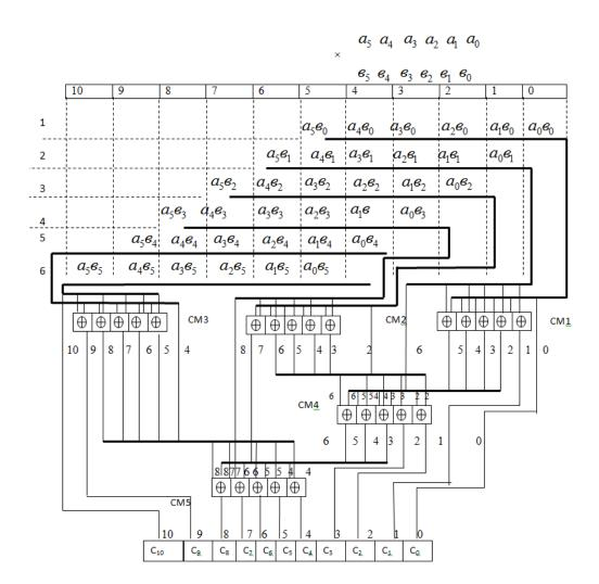
Рис. 3. Схема умножения 6-разрядных полиномов A и B на дереве сумматоров
