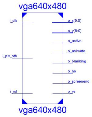
Рисунок 4. Блок драйвера VGA
