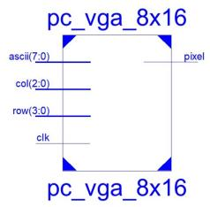
Рисунок 6. Блок-схема преобразователя ASCII коды символов в изображении размером 8x16 пикселей
