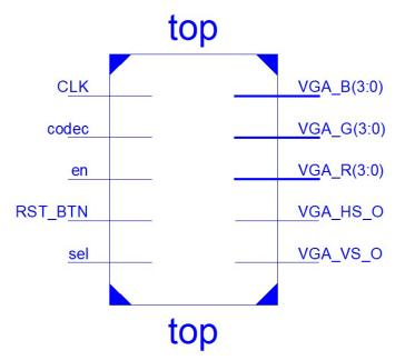
Рисунок 2. Блок-схема основного устройства вывода информации в VGA дисплей
