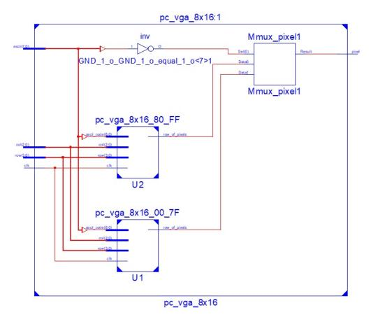
Рисунок 7. Преобразователь ASCII коды символов в изображении
