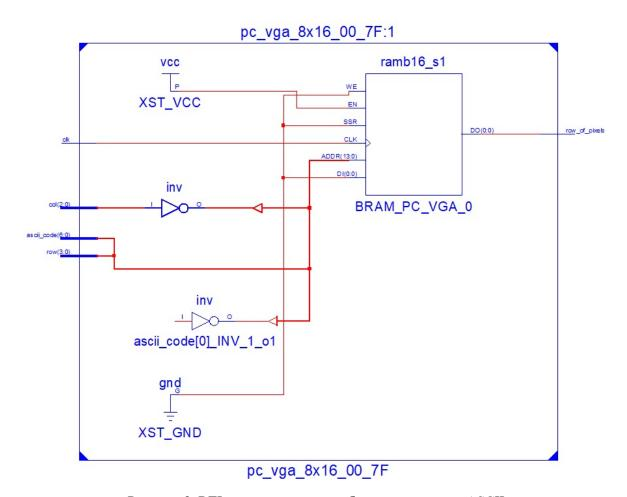
Рисунок 9. RTL схема модуля преобразователя кодов ASCII
