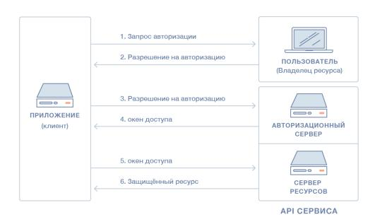
Рис. 2. Последовательность аутентификации и авторизации
