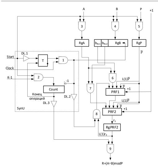
Рис. 1. Функциональная схема умножителя чисел по модулю с анализом двух старших разрядов множителя
