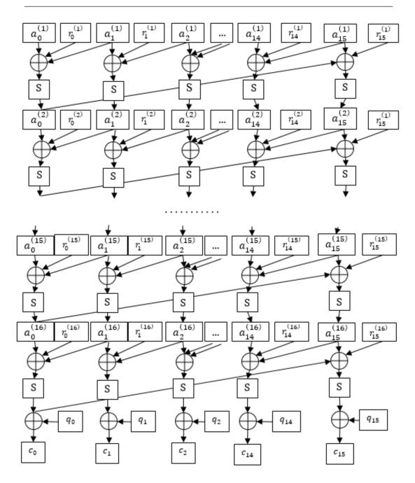
Рисунок 1 – Схема алгоритма шифрования AL01
