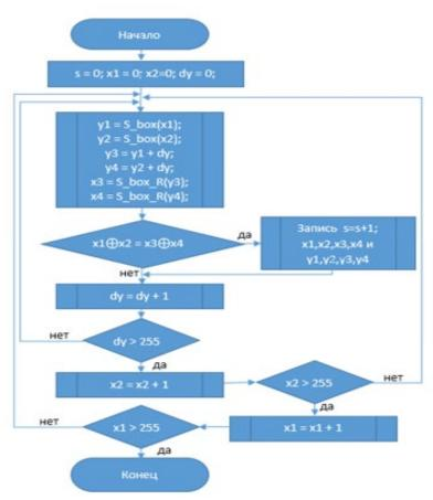
Рис. 2 Блок-схема алгоритма поиска квартетов по преобразованию S-блока
