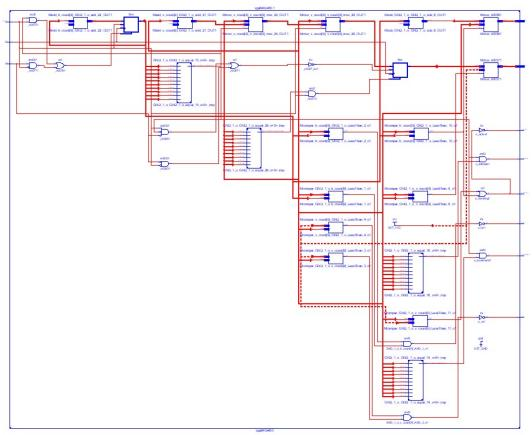
Рисунок 5. RTL схема драйвера VGA
