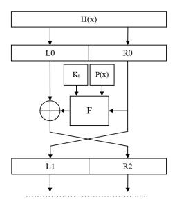
Рис. 2. Схема применения сети Фейстеля
