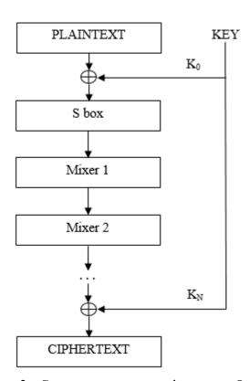
Рисунок 2 – Схема алгоритма зашифрования «Qamal»
