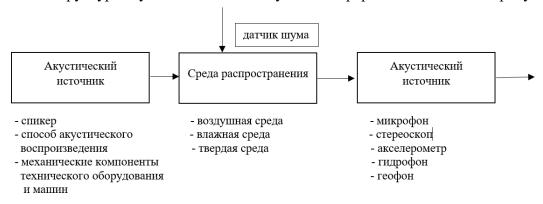
Рис. 1 Структура акустического канала утечки информации.
