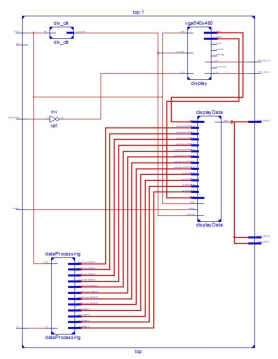
Рисунок 3. Блок-схема внутренней структуры основного блока вывода информации в VGA дисплей
