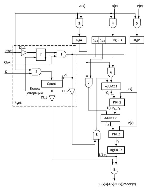
Рис.1. Функциональная схема умножителя полиномов по модулю Неприводимого полинома с анализом двух старших разрядов множителя за шаг
