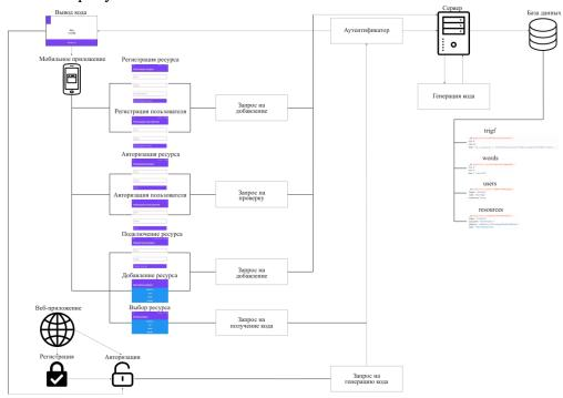
Рис. 2– Модель защиты информационных систем на основе предложенной двухфакторной аутентификации
